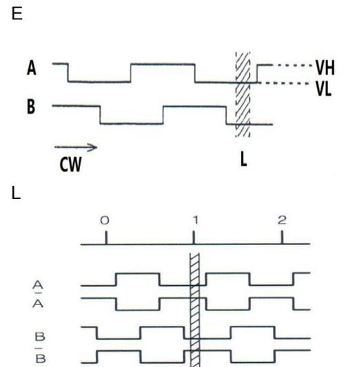
刻度盤停頓位置在斜線範圍內與其配合的設備必須確認停頓位置
